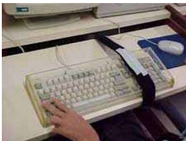
Fig. 6 - Máscara de teclado encaixada no mesmo
